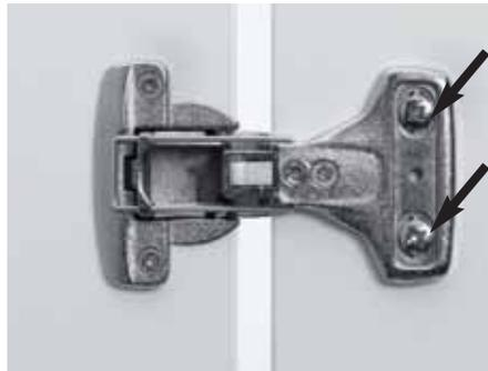
Verstellung über Langlöcher (Fixierzapfen ausbrechen) Verstellbereich ±2 mm Nach Verstellung 3. Schraube setzen.
