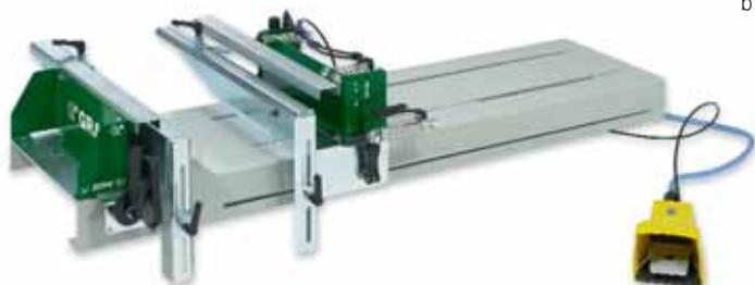
Montagegerät für den Zusammenbau von DWD XP Schubkasten und Frontauszug bis zu 120 mm Korpusbreite.
