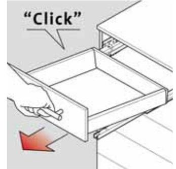
**Waagrecht** mit Schwung ausziehen, bis der Schubkasten hörbar entriegelt, dann abheben.
